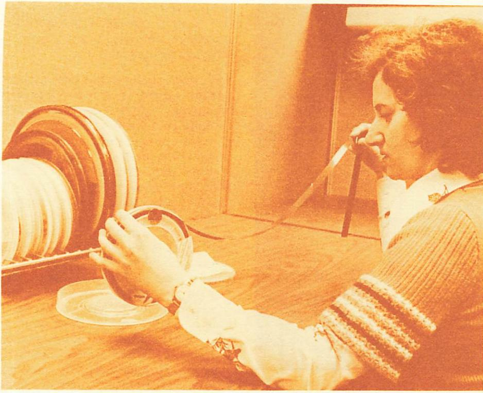
On inspecte régulièrement les bandes magnétiques afin d'y déceler des signes de détérioration ou des défauts, et on les répare si possible. [C 98091]
