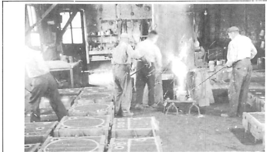
Le fourneau déverse la fonte en fusion que les "couleux" prélèvent au moyen de pots individuels, tandis que le fondeur (O. Lavoie, à droite) s'apprête à boucher le trou d'alimentation.
