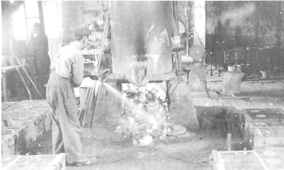
F. Lavoie arrose les restants de fonte, charbon, scories etc. du tourneau. On procédera ensuite au démoulage des pièces coulées en renversant les boîtes sur le sol.
